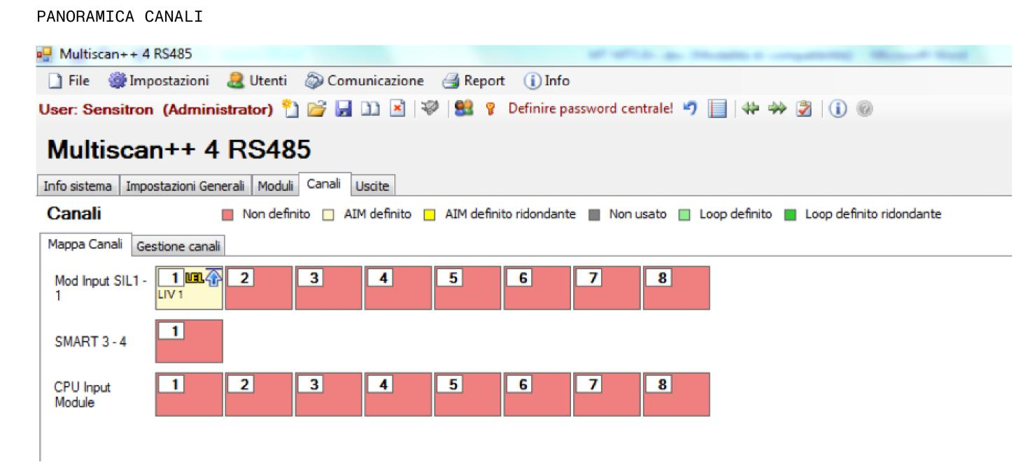
La Panoramica Canali da un'immagine riassuntiva di quanti moduli Input e di quanti rilevatori è composto il sistema, di quanti di questi sono definiti (rettangolino con i dati presenti all'interno) e se i rilevatori sono collegati in centrale (CPU Input Module) o tramite moduli Input (Mod Input SIL1) oppure direttamente (sensori indirizzati). Colori differenti rappresentano le diverse modalità del rilevatore: non definito, definito, ridondante ecc.
