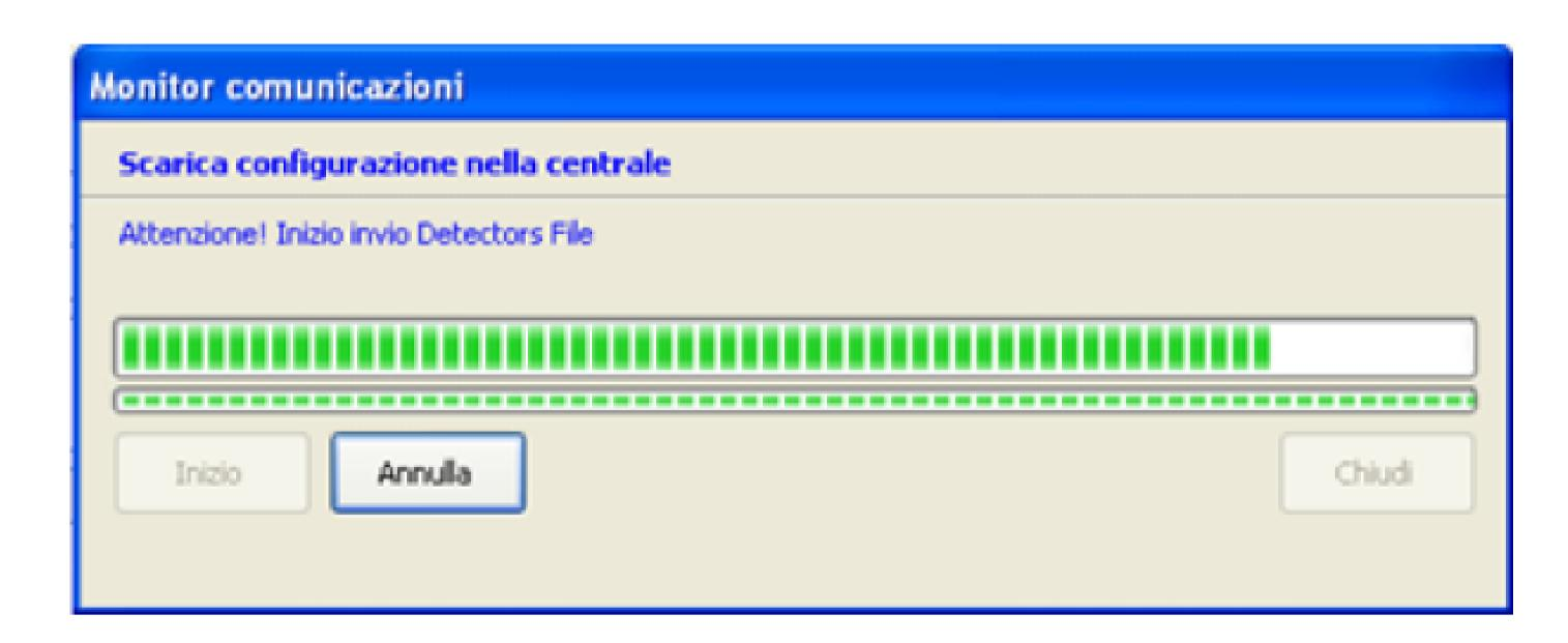
"Carica configurazione da Centrale" è la procedura contraria allo scarico dati. Permette di caricarsi dalla centrale il file d'impianto (programmazione residente nella centrale). La sequenza delle operazioni è la medesima che per lo scarico dati, vedi sopra. Al termine del carico dati, il file d'impianto viene automaticamente salvato nell'apposita cartella del PC.
