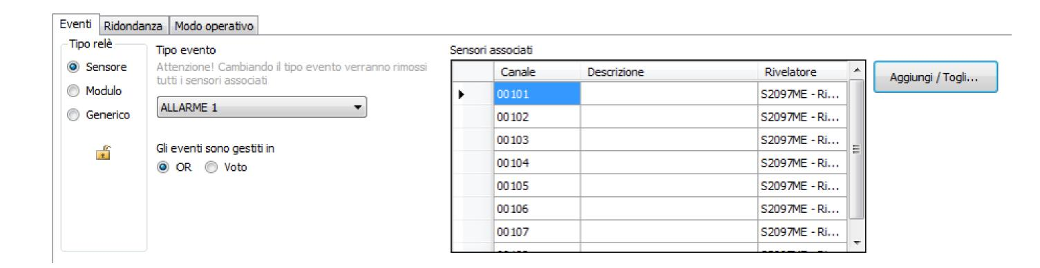
Evento "Modulo": Selezionare Evento Modulo ed associare come tipo di evento Fault Modulo (Fault generico di un modulo IN o OUT) oppure Modulo OFFLINE (Guasto comunicazione di un modulo IN o OUT).
