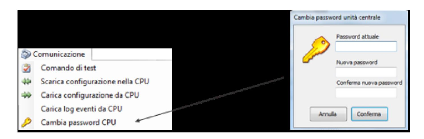
"Scarica configurazione nella Centrale" permette di scaricare il file d'impianto creato nella centrale rivelazione gas.
