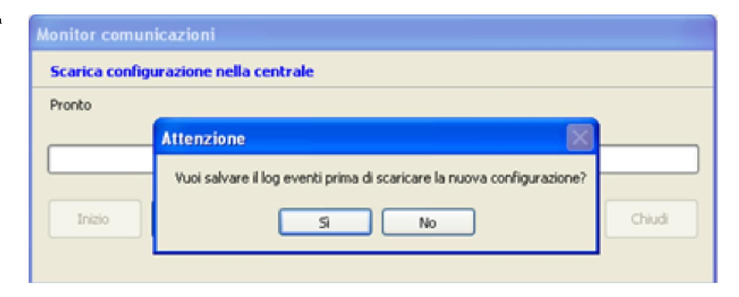
Prima dell'avvio della procedura di carico e scarico dati un messaggio di attenzione chiede se si intende salvare la memoria eventi della centrale. Questo perché scaricando una nuova configurazione con dei dati diversi dai precedenti (nuovi rilevatori gas, zone e moduli impianto, nuovi utenti ecc.) la memoria eventi della centrale potrebbe non essere più reale. Si suggerisce quindi di salvare sul PC la memoria eventi della centrale cliccando su Si.
