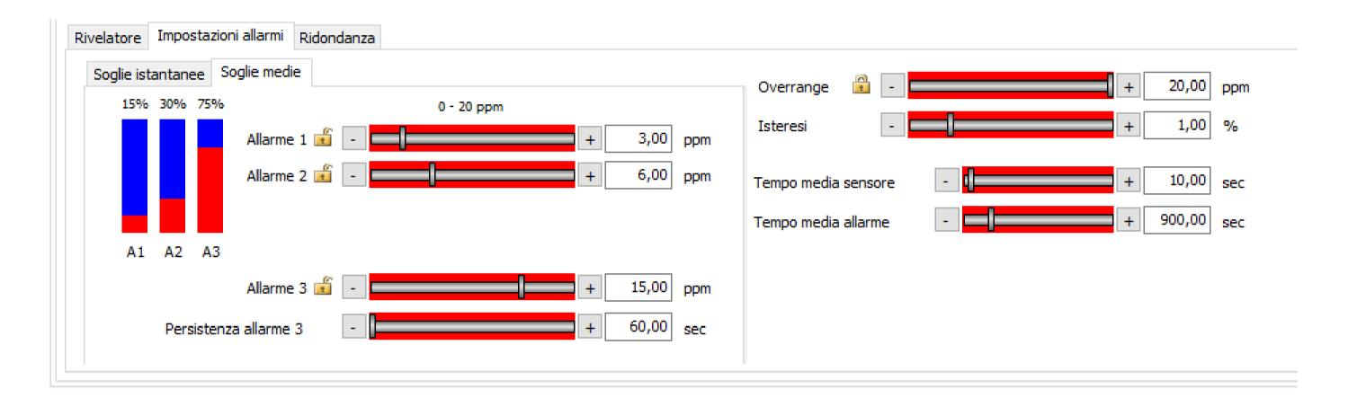
L'impostazione e le modalità operative delle soglie di allarme è diversa a seconda del tipo di centrale (Industrial o Park), del Profile e del Gas Type che si è scelto. Le modalità sono due: Soglie Mediate e Soglie Istantanee.
