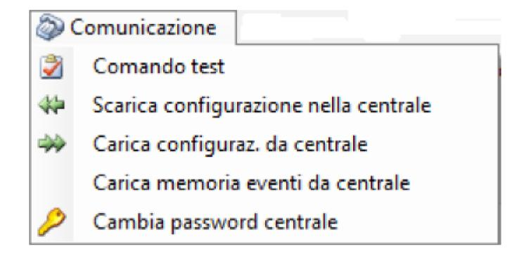
"Comando Test" permette di controllare il corretto collegamento tra centrale e PC. Ogni volta che si procede ad uno scambio dati tra la centrale rivelazione gas e il PC, per stabilire il collegamento, il programma richiede l'inserimento di una password (Password Seriale). La password inserita viene confrontata con quella residente nella centrale ed il collegamento viene instaurato.
